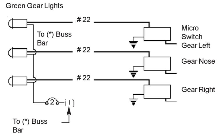
DIODES FOR TRANSITION LIGHT. USE ANY COMMON 1/4 WATT RECTIFIER DIODE.
